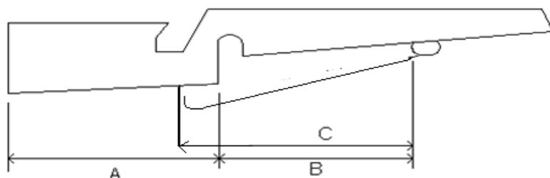
A : Distance de la face arrière de la plaque de couche à la face avant de la poignée.
